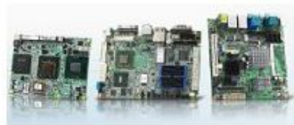
各種機器の制御、演算、表示機能を担う 組み込み用シングルボードコンピュータ
